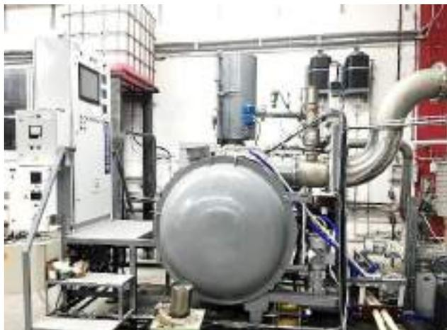
Электropечь ИППВ 0.025 предназначена для выплавки сплавов и получение отливок высокого качества в вакууме и в атмосфере инертного газа (гелия, аргона).
