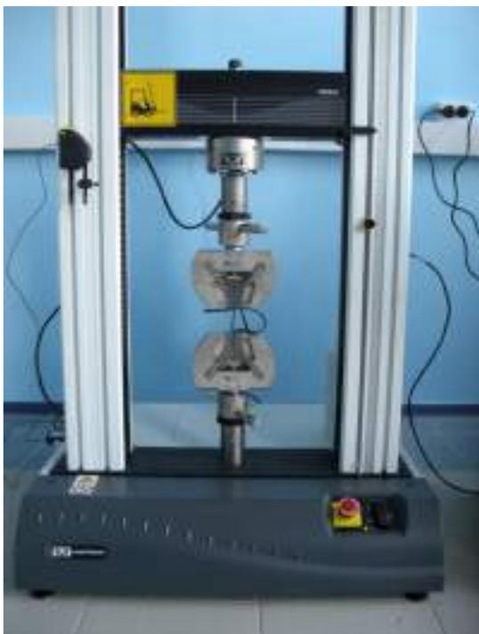
Оборудование предназначено для статических испытаний на растяжение, сжатие и изгиб в широком диапазоне скоростей деформирования при комнатной температуре по ГОСТ 1497-2023, ГОСТ 10006-80, ГОСТ 12004-81, ГОСТ 6996-66, ГОСТ 8817-82, ГОСТ 25.503-97, ГОСТ ISO 9585-2011 и др.
