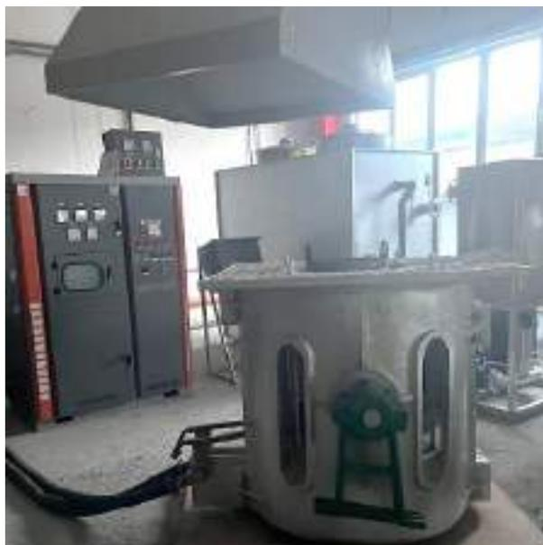
Электродпечь ИПП-400/500Ч предназначена для выплавки черных металлов и сплавов в литейных цехах металлургических и машиностроительных заводов. Выплавка производится путем переплава шихты, или лома токами средней частоты в индукционной тигельной электродпечи.
