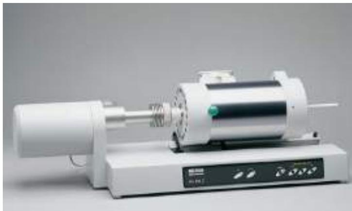
Дилатометр горизонтальный с толкателем DIL 402 C предназначен для измерений линейных приращений и температурного коэффициента линейного расширения (ТКЛР) твердых, пастообразных, порошкообразных и жидких материалов. Из результатов измерений может быть получены значения точки (температуры) размягчения, температуры стеклования, температуры фазовых
