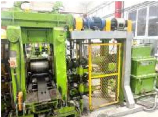
2-х валковый реверсивный стан предназначен для листовой прокатки металлических материалов: титановые, алюминиевые, медные, магниевые сплавы и стали. С возможностью контроля усилий, скорости прокатки, нагрева валков. При использовании совместно с печью позволяет осуществлять прокат в широком температурном интервале, вплоть до 1200°C.
