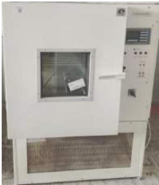
Климатическая камера предназначена для проведения климатических испытаний (в том числе циклических) и других лабораторных исследований. Камера позволяет имитировать агрессивные условия окружающей среды для проведения лабораторных испытаний, моделировать и поддерживать заданный режим на протяжении длительного времени для реализации технологического процесса.
