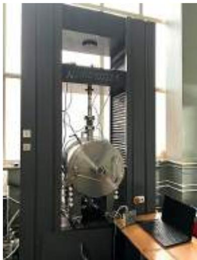
Для статических испытаний на растяжение образцов с максимальным усилием до 600 кН. Использование дополнительных датчиков силы на 1 кН и 5 кН и специально спроектированной вакуумной печи ВРНИ1700 позволяет проводить испытания на растяжение и сжатие вплоть до 1600°C.
