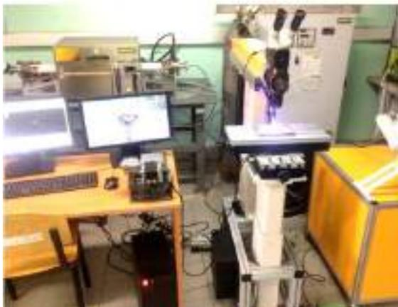
Установка предназначена для лазерной сварки и наплавки различных металлов и их сплавов. Конструкция установки рассчитана на использование систем линейного перемещения (координатные столы) и устройств вращения различного размера, а также позволяет работать как с маленькими деталями, так и с изделиями больших габаритов и весов. На лазерной установке можно также осуществлять работы по гравировке и маркировке различных поверхностей, резке тонкого металла.
