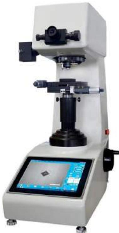
Для измерений твердости металлов и сплавов, поверхностных слоев металла, гальванических и других покрытий в соответствии с ГОСТ 2999-75.
