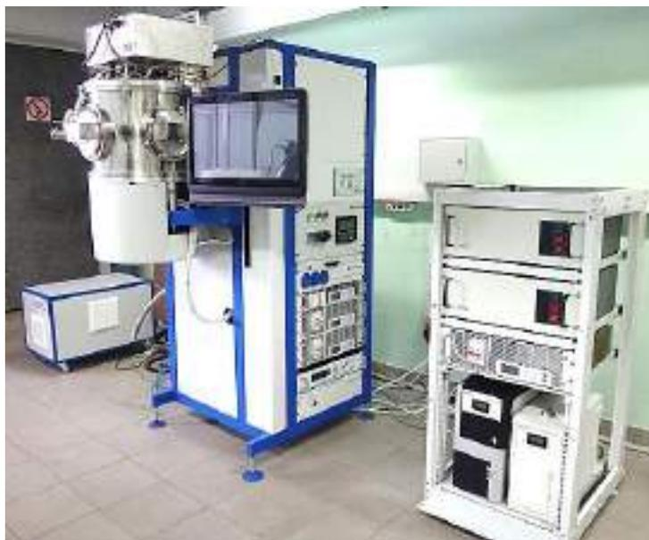
Установка на базе комплекса технологических установок Ника-2012 предназначена для мелкосерийного нанесения функциональных, диэлектрических, твёрдых и износостойких покрытий магнетронным и дуговым способом. Установка позволяет напылять многокомпонентные и многослойные покрытия.
