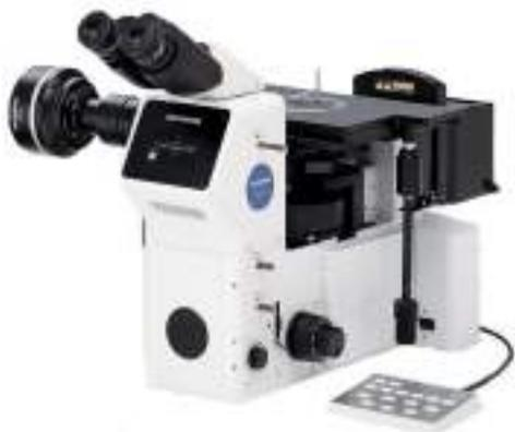
Микроскоп OLYMPUS GX71 – это системное исследовательское устройство из числа моделей, входящих в линейку инвертируемых микроскопов. Оборудование позволяет использовать различные методы исследований образцов в металлографии и используется для проверки характеристик микроструктуры получаемых материалов и готовых изделий в производственном процессе. Прибор позволяет автоматизировать процедуру исследования для проверки большого количества образцов. Осо-
