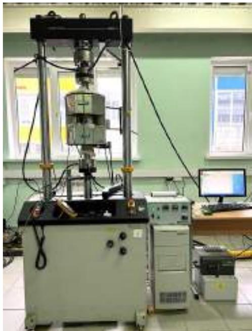
Оборудование предназначено для определения характеристик трещиностойкости (вязкости разрушения) при статическом нагружении по ГОСТ 25.506-85, скорости роста усталостной трещины по ASTM E 647, испытаний на много- и малоцикловую усталость при растяжении – сжатии, изгибе по ГОСТ 25.502-79.
