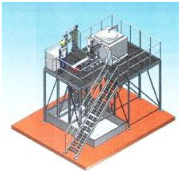
Оборудование предназначено для производства круглых заготовок алюминия (алюминиевых сплавов) методом полунепрерывного литья.
