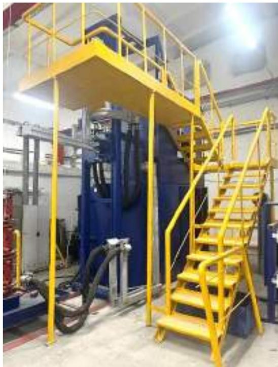
Установка предназначена для получения слитков из сплавов чёрных и легированных металлов методом электрошлакового переплава в кристаллизаторах переменного сечения. Установка применяется в литейном производстве для переплава углеродистых, нержавеющей, жаропрочных сплавов.
