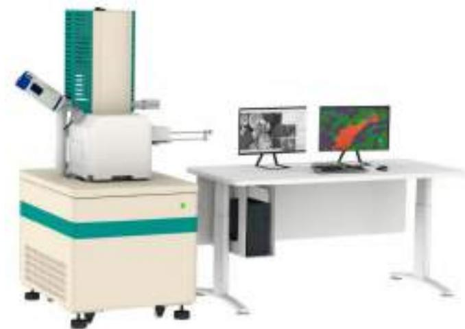
Сканирующий электронный микроскоп WIN SEM A8000 предназначен для получения изображений, измерений линейных размеров, определения формы, ориентации и других параметров, нано- и микроструктур поверхностей различных объектов.
