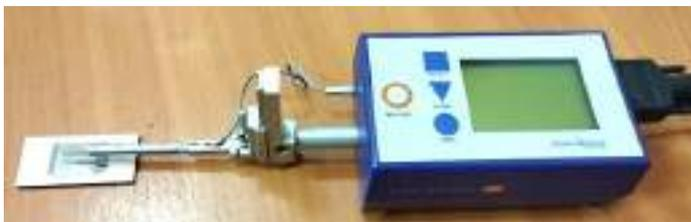
Профилометр применяется для определения параметров шероховатости поверхностей изделий, сечение которых в плоскости измерения представляет прямую линию. Измерение линейного профиля поверхности проходит
