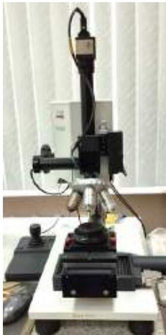
Скретч-тестер предназначен для практического определения механических характеристик при разрушении пленок и покрытий, толщиной до 1 мм (в зависимости от материала покрытия): адгезия, когезия, хрупкость, деформация, отслаивание, а также устойчивость и сопротивление к царапанию (метод склерометрического испытания); микротвердость.
