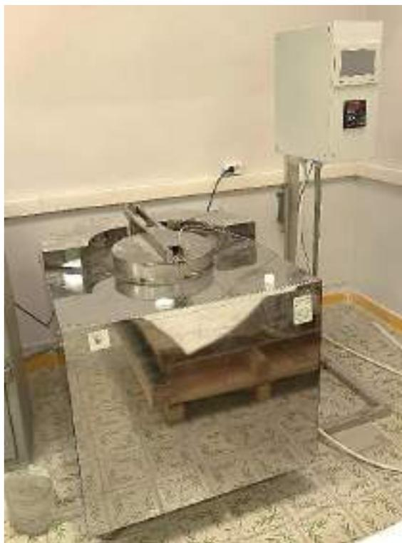
Предназначена для нагрева и охлаждения деталей до температур 150-1000°C при термической обработке сталей и сплавов в расплавах солей.
