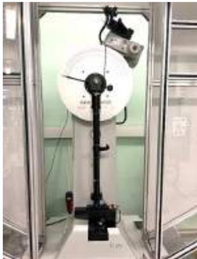
Копер предназначен для динамических испытаний на ударную вязкость как стандартных образцов по методу Шарпи при пониженной, комнатной и повышенных температурах в соответствии с требованиями ГОСТ 9454-78, ГОСТ 22848-77, так и миниатюрных образцов по требованиям стандарта DIN 50115 с записью диаграммы нагрузка-прогиб и нагрузка-время.
