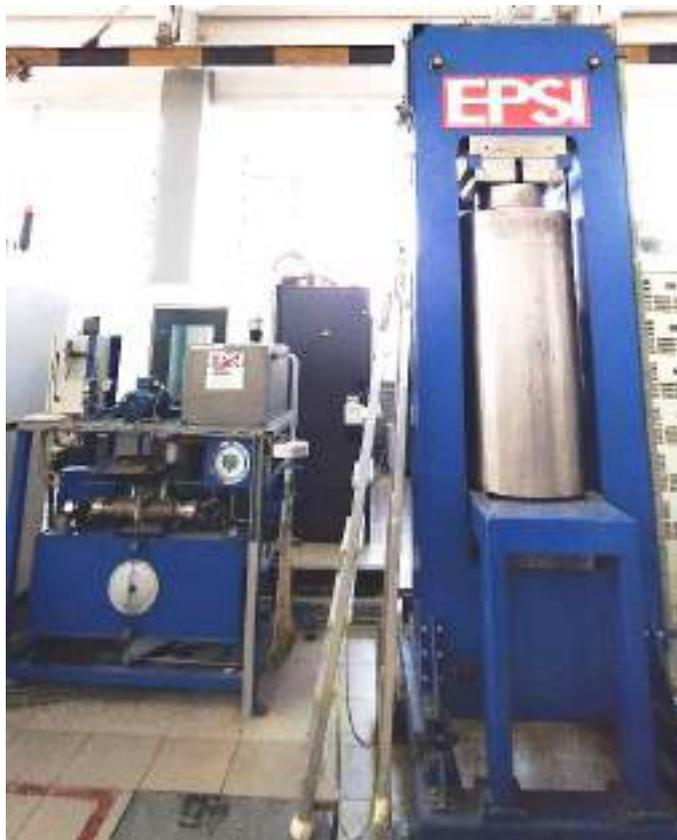
Изостатический пресс предназначен для технологической обработки материалов посредством равномерного, всестороннего сжатия. Формообразующая методика, при которой высокое гидростатическое давление прикладывается к порошку (металлическому или керамическому) при температуре окружающей среды. Вода используется как среда, передающая давление. Преимущества – пригодность для изделий сложной формы, повышенная плотность и прочность прессовок, возможность прессования без связки.
