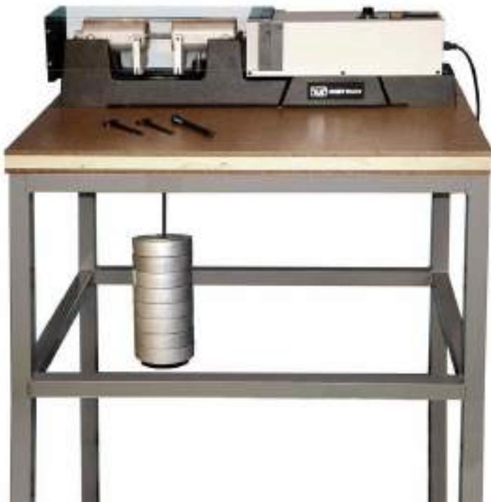
Для испытания на многоцикловую усталость цилиндрических образцов по схеме четырехточечного изгиба с вращением. Испытания могут проводиться как при комнатной, так и при повышенной температуре по ГОСТ 25.502-79.
