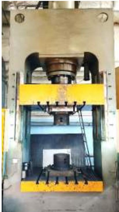
Гидравлический универсальный пресс с усилием 4000 кН предназначен для изготовления изделий из пластмасс методами компрессионного (прямого) и трансферного (литьевого) прессования, формовки неметаллических материалов (древесные отход, керамика и т.п.), листовой штамповки (гибка, вытяжка, вырубка), правки плоских и круглых деталей, а также прессовании спец. веществ.
