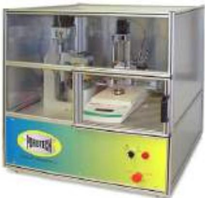
Автоматизированный эталонный поромер Porotech 3.1 предназначен для неразрушающего измерения пористости, объема пор, их радиусов и распределения пор по размерам, оценка контактного угла смачивания, а также гидрофильно-гидрофобных свойств многокомпонентных материалов. В приборе реализован метод порометрии, основанный на законах капиллярного равновесия. По известным порометрическим кривым – распределениям объема и площади пор по диаметрам пор образцов, входящих в комплект поро-
