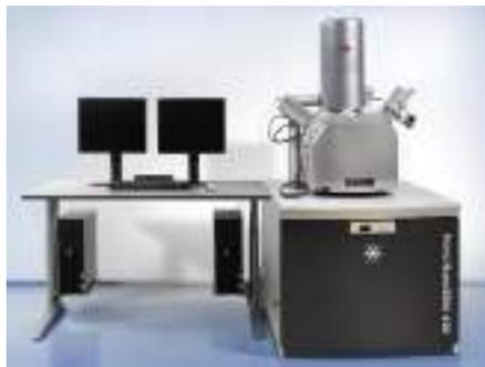
Микроскоп электронный растровый Nova NanoSEM 450 с системами для энергодисперсионного микроанализа, микроанализа с волновой дисперсией и системой анализа дифракции обратно рассеянных электронов, представляет собой стационарный лабораторный прибор для получения изображений, измерений линейных размеров, определения формы, ориентации и других параметров.
