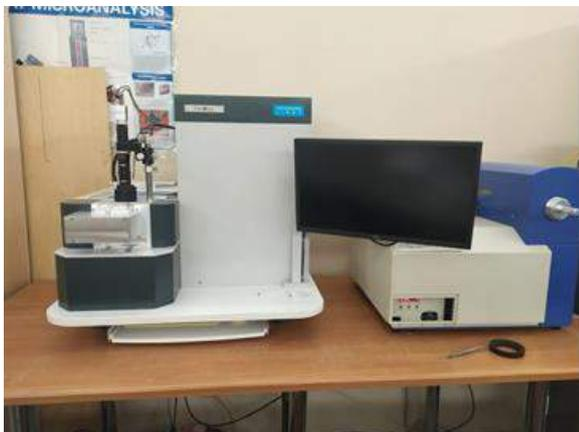
Ионная мельница UniMil предназначена для изготовления объемных образцов и подготовки их поверхности для нужд просвечивающей электронной микроскопии и EBSD-анализа. Ионная мельница оборудована двумя пушками: с высокой энергией энергиями (5 – 16 кэВ) и низкой (100 эВ – 1 кэВ) энергиями ионов.
