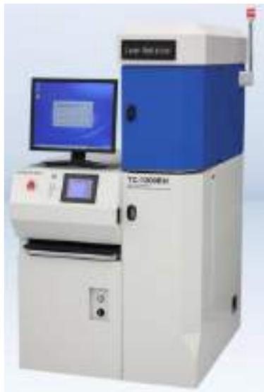
Прибор предназначен для оценки характеристик теплопроводности широкого спектра материалов, таких как термоэлектрические материалы, углеродные материалы, полупроводники, керамика, металлы и др. Система измеряет методом лазерного импульса три тепловые константы – температуропроводность, удельную теплоемкость и теплопроводность.
