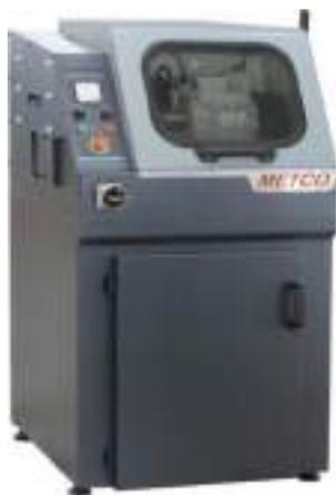
Chennai Metco Vaincut M напольный абразивный отрезной станок общего назначения. Резка образца осуществляется путем опускания диска с помощью рукоятки (движение по оси Z). Станок оборудован системой рециркуляции охлаждающей жидкости.
