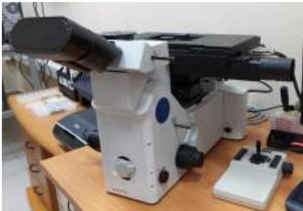
Микроскоп Olympus GX51 является представителем семейства инвертируемых микроскопов, предназначенных для решения всего спектра контрольно-измерительных и исследовательских задач в материаловедении. Оборудование позволяет вести наблюдение в отражённом и поляризованном свете, обеспечивать фиксацию результатов с применением фотокамеры. Микроскоп Olympus GX51 – универсальный оптический
