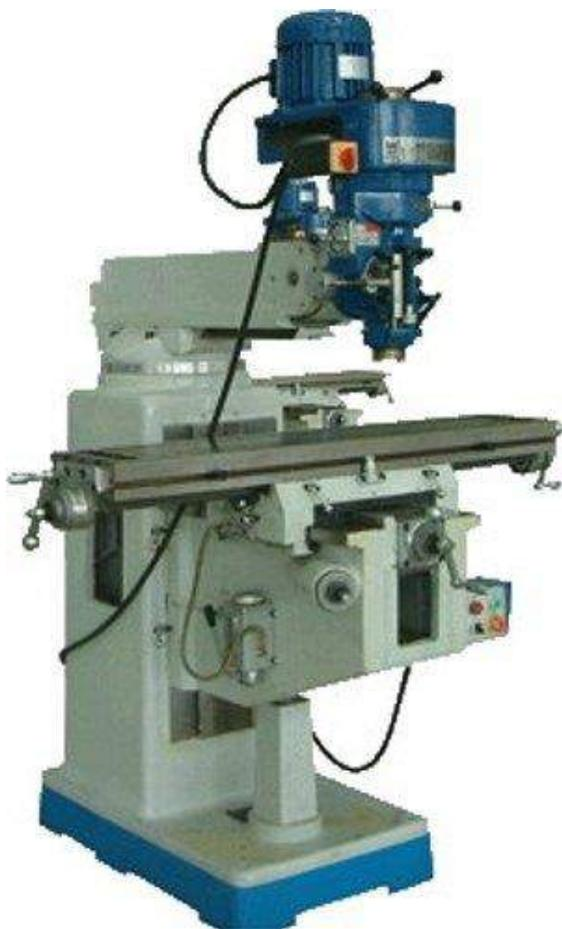
Фрезерный станок предназначен для выполнения различных фрезерных операций для нужд общего машиностроения, выполняемых с помощью цилиндрических, дисковых, фасонных, торцевой, модульных, червячных и других фрез. Простота обслуживания и быстрая переналадка приспособлений и инструмента представляют значительные удобства при использовании станка в мелкосерийном производстве.
