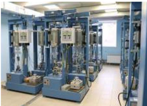
Машина рычажного типа предназначена для проведения испытаний на ползучесть по ГОСТ 3248-81 и длительную прочность по ГОСТ 10145-81 металлов и сплавов при температурах до 1000°C. Конструкция машины и оснастки позволяет проводить испытания на коррозию под напряжением по ГОСТ 9.901.1-87. В ЦКП в наличии 28 рам для испытаний.
