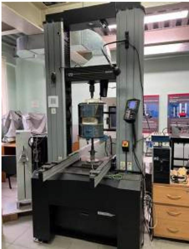
Оборудование предназначено для статических испытаний на растяжение, сжатие и изгиб в широком диапазоне температур и скоростей деформирования по ГОСТ 1497-2023, ГОСТ 9651-84, ГОСТ 19040-81, ГОСТ 10006-80, ГОСТ 12004-81, ГОСТ 6996-66, ГОСТ 8817-82, ГОСТ 25.503-97, ГОСТ ISO 9585-2011 и др.
