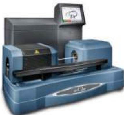
Прибор представляет собой совмещенный ТГА/ДТА/ДСК анализатор, который позволяет одновременно использовать три метода термического анализа – термогравиметрию, дифференциальный термический анализ и дифференциальную сканирующую калориметрию. Прибор использует для измерений одновременно исследуемый образец и образец сравнения. Области применения – минералогия, металлургия, разработка и исследование новых материалов.
