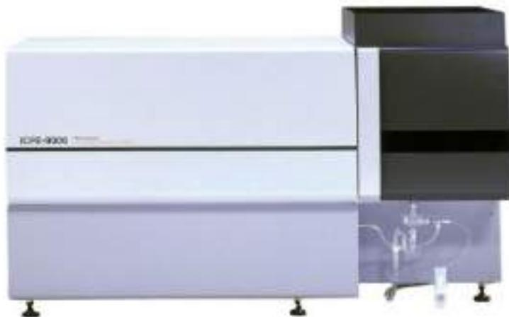
Спектрометр эмиссионный с индуктивно-связанной плазмой ICPE 9000 предназначен для количественного анализа жидких проб при определении состава металлов и сплавов, пищевых продуктов, почв и пр. элементов пробы в аргонной плазме, возбуждаемой высокочастотным разрядом.
