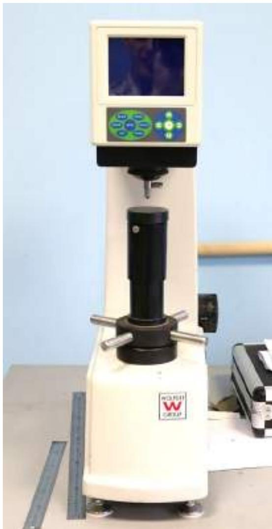
Стационарный твердомер предназначен для измерения твердости металлов и сплавов по шкалам Роквелла, в соответствии с ГОСТ 9013-59.
