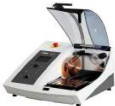
Secotom-50 универсальный настольный отрезной станок с автоматической подачей используется в материаловедении для пробоподготовки образцов путем их разрезания. В качестве материалов для заготовок может выступать как металл, керамика, композиционные материалы, кристаллы, минералы и пр. Станок оборудован системой рециркуляции охлаждающей жидкости.
