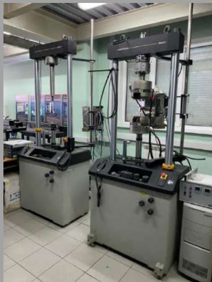
Циклические испытания INSTRON 8801 Нагрузка 10 тонн Изгиб/растяжение/сжатие
